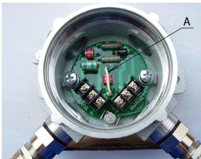
Рисунок 2.1 – Вид УЗИП ТЕРМ 001 (стрелкой указан провод «А»)
